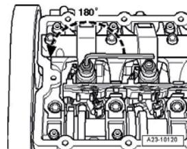
**8** Maintenez la vis de réglage dans cette position et serrez-la au couple de serrage spécifié par le fabricant.
