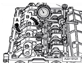
**7** Retirez le produit. Vissez la vis de réglage dans le culbuteur jusqu'à sentir une résistance (l'injecteur pompe est en butée). Lorsque la butée est atteinte, dévissez la vis de réglage en la tournant : **selon les spécifications du fabricant (en fonction du type de moteur).**
