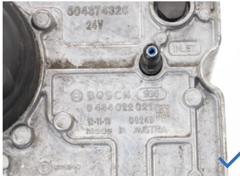
Aucun dommage au connecteur électronique
