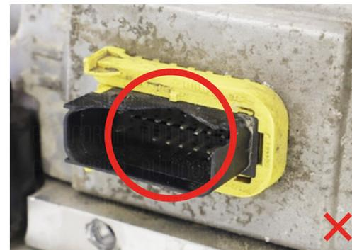
Connecteur du capteur de pression endommagé
