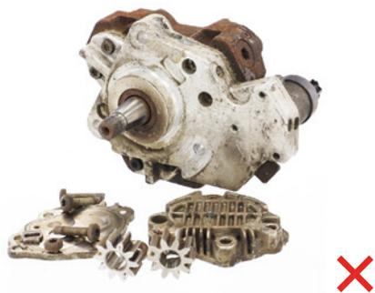
Corrosion au niveau de l'arbre de transmission
